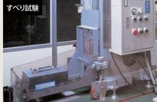
●LIXILでは、屋外床の使用場面が想定される床タイルには、紳士靴で水と汚れ(ダスト)の介在物の上を歩行する状態の実際の使用場面に近いすべり試験で品質管理を行っています。すべりの値によって人が安全と感じるか、すべて危険と感じるかの相関が分かる試験方法です。
