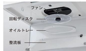
回転ディスクが煙の中の油をしっかりキャッチ。遠心力で油をとばしてオイルトレイに集めます。
